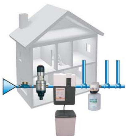
Схема показывает в какой последовательности нужно подключать установки JUDO после счетчика воды: фильтр обратной промывки PROFI PLUS, умягчитель QUICKSOFT DUO и дозирующий насос JULIA
