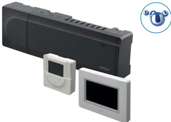
Проводной комплект управления системой напольного отопления/охлаждения. Контроллер посылает и принимает сигналы от комнатных термостатов, датчиков и управляет исполнительными механизмами и другим отопительным/охлаждающим оборудованием. Дополнительные контроллеры (суммарно до 16-ти) могут использоваться для работы в единой системе. Информация о системе и управление через панель управления.
